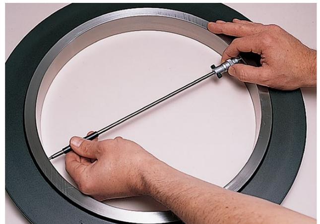
**HARDENED AND GROUND ANVILS ON RODS, ADJUSTABLE FOR LENGTH. HEAD ANVIL IS HARDENED AND GROUND**
