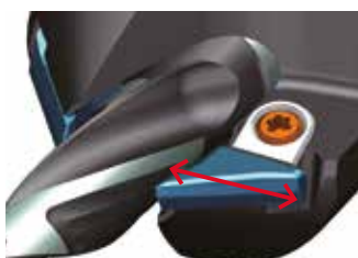
Płytki przesuwają się w kierunku promieniowym, dostosowując się do średnicy wiercenia
