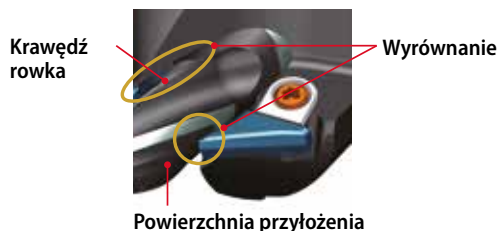
Rys. 4 Wyrównanie wiertła DRA
