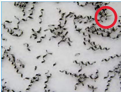
With chipbreaker HH chipbreaker
