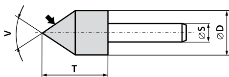
Ściernica trzpieniowa walcowo - stożkowa 5211 - D × T × S - V
