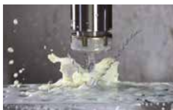
Opróżnianie pod ciśnieniem 1,5 MPa (15 Barów)
