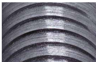
Po gwintowaniu 184 otworów za pomocą VUSP CH wykończenie powierzchni jest nadal doskonałe.
